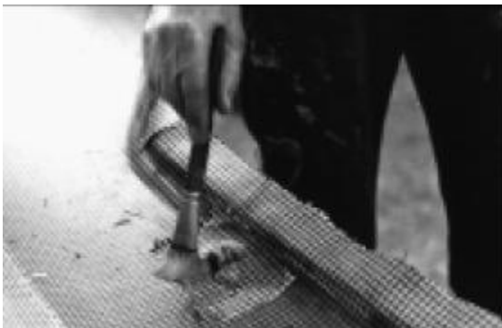
Attēls 4. Līmētā lamināta piemērā tiek piesūcināts ogļšķiedras-aramidšķiedras audums ar epoksīda sveķiem planiera korpusam.
